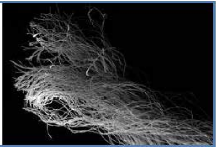
Liflerde kıvrım öncesi ve sonrası (tektüre işlemi uygulanmış) Before and after curling in fibers (texturizing process applied)
