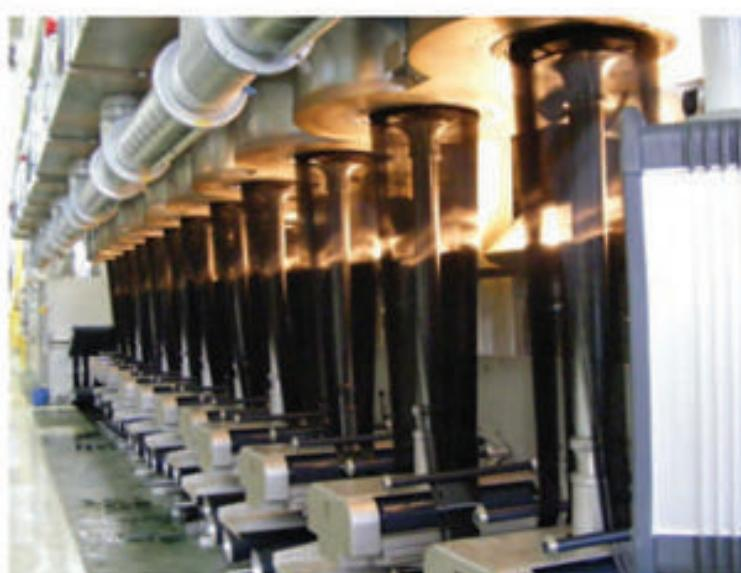
ve uzayan halat, istenilen denye ve filament inceligiine düşürülür. Banyonun giriş ve çıkış kismına bakan çekim millerinin üzerinde kauçuk mil ile baskı yaparak halatin kayması, kağıması ve çekimin bozulmasına engel olunur.
